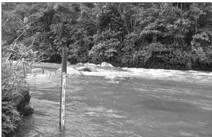
El observador de la comunidad de Cielo Verde viene dos veces por día a leer la regla y anotar el nivel del Manduriaco Grande. Esto permite conocer las variaciones de los niveles de agua, datos esenciales para determinar el caudal del río.
